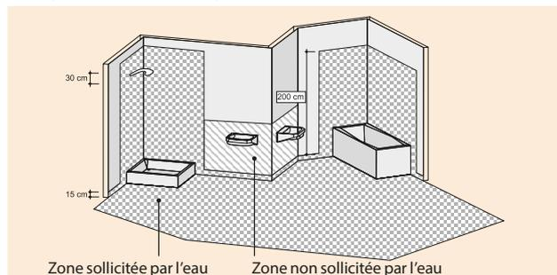
D'autre part, la totalité de la zone d'un local comportant une douche ou une baignoire doit être étanchéée avec une bande d'étanchéité FERMACELL.
